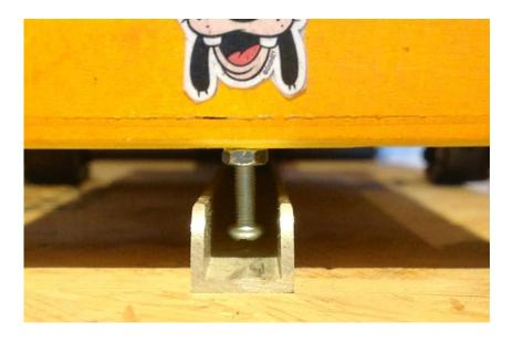
Die 3 mm Maschinenschraube soll die Führungsschiene nur seitlich berühren und wird deshalb so eingestellt, dass sie nach unten genug Abstand hält.
