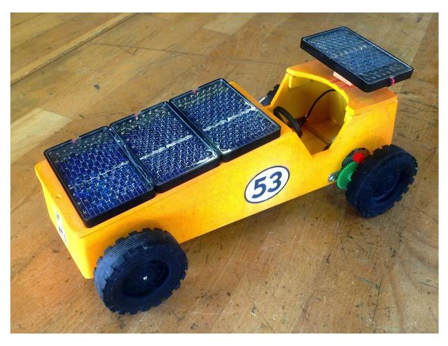
Der Solarrenner "CC2.0" wird von 4 gekapselten Solarzellen versorgt, die ihre Energie direkt von der Sonne bekommen. Bei guter Sonneneinstrahlung erzeugen sie ungefähr 4 Volt und 0,2 Ampere. Ein Solarmotor treibt über ein Zahnradgetriebe mit einer Untersetzung von 16: 1 die Hinterachse an und überträgt so die Energie an die Hinterräder.
